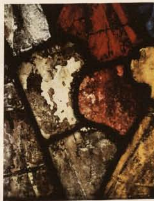
Abb. 8a-b. Nürnberg, St. Sebald, Fenster sV (Schürstab-Fenster), Detail im Auflicht: originale Oberfläche größtenteils erhalten, aber eingebettet in dichte Korrosionskrusten (a); und im Durchlicht: Bemalung durch starke „Verbräunung“ der Korrosionskrusten kaum noch lesbar (b).
